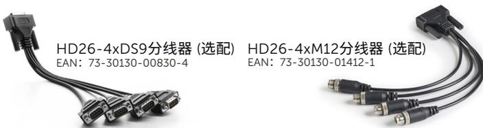
Kvaser PCIe 8xCAN 设备具有两个 26 针 HD D-SUB 连接器,每个连接器提供四个通道。每个 HD26-4xDS9 分线器可用于连接四个独立的 9 针 D-SUB 连接器。另外,每个 HD26-4xM12 分线器可用于连接四个独立的 5 针 M12 连接器。
