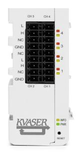
Figure 15: LEDs on the Kvaser DIN Rail SE400S-X10.
