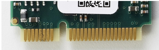
Figure 2: Mini PCI Express connector
