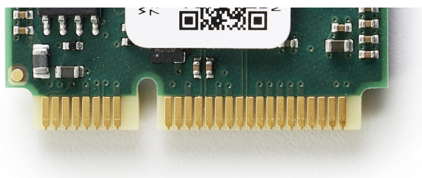
Figure 2: Mini PCI Express connector on Kvaser Mini PCI Express 2xCAN v3
