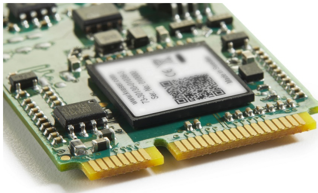
Figure 2: Mini PCI Express connector
