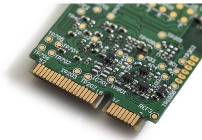
Figure 2: Kvaser Mini PCI Express
