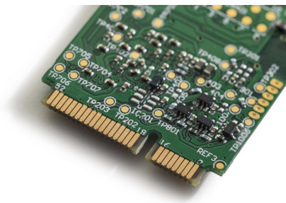
Figure 2: Kvaser Mini PCI Express
